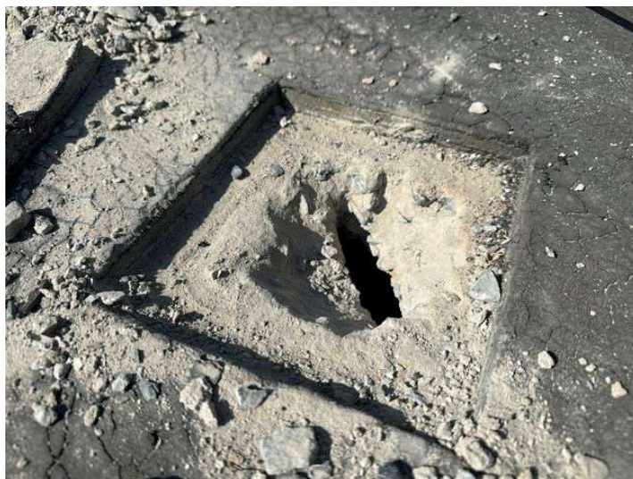
Foto 21: Pohled na provedenou sondu S2
