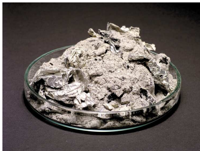
popel ze spalování dřeva s domovním odpadem
