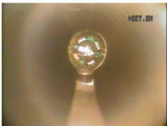
Obr.2: Orientace dvou sloupců perforačních štěrbin v místě měření směru horizontálního proudění
